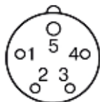
Рис. 5 Схема контактов на вилке
