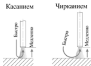
Рис. 7.2. Способы зажигания сварочной дуги.
